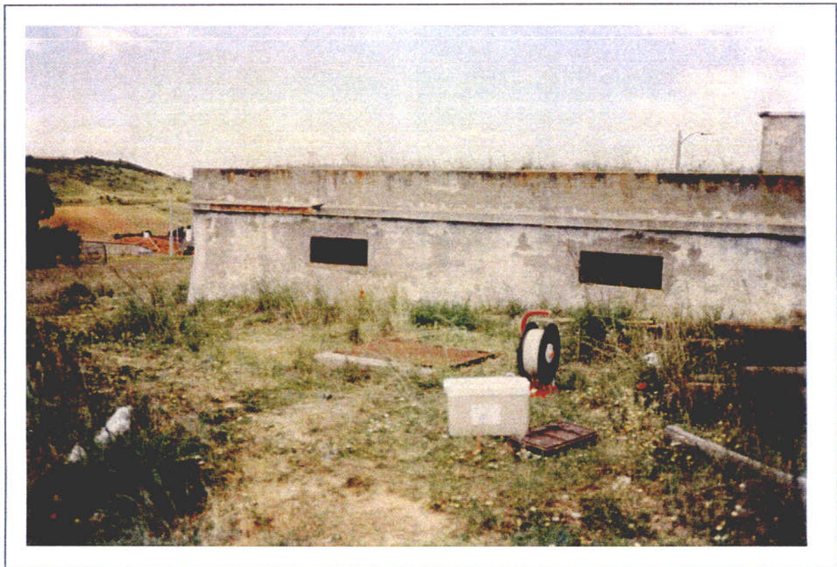
Foto 52. Situación del sondeo detrás del depósito. En el extremo izquierdo de la foto se observa la salida del sondeo, donde se recoge la muestra.
